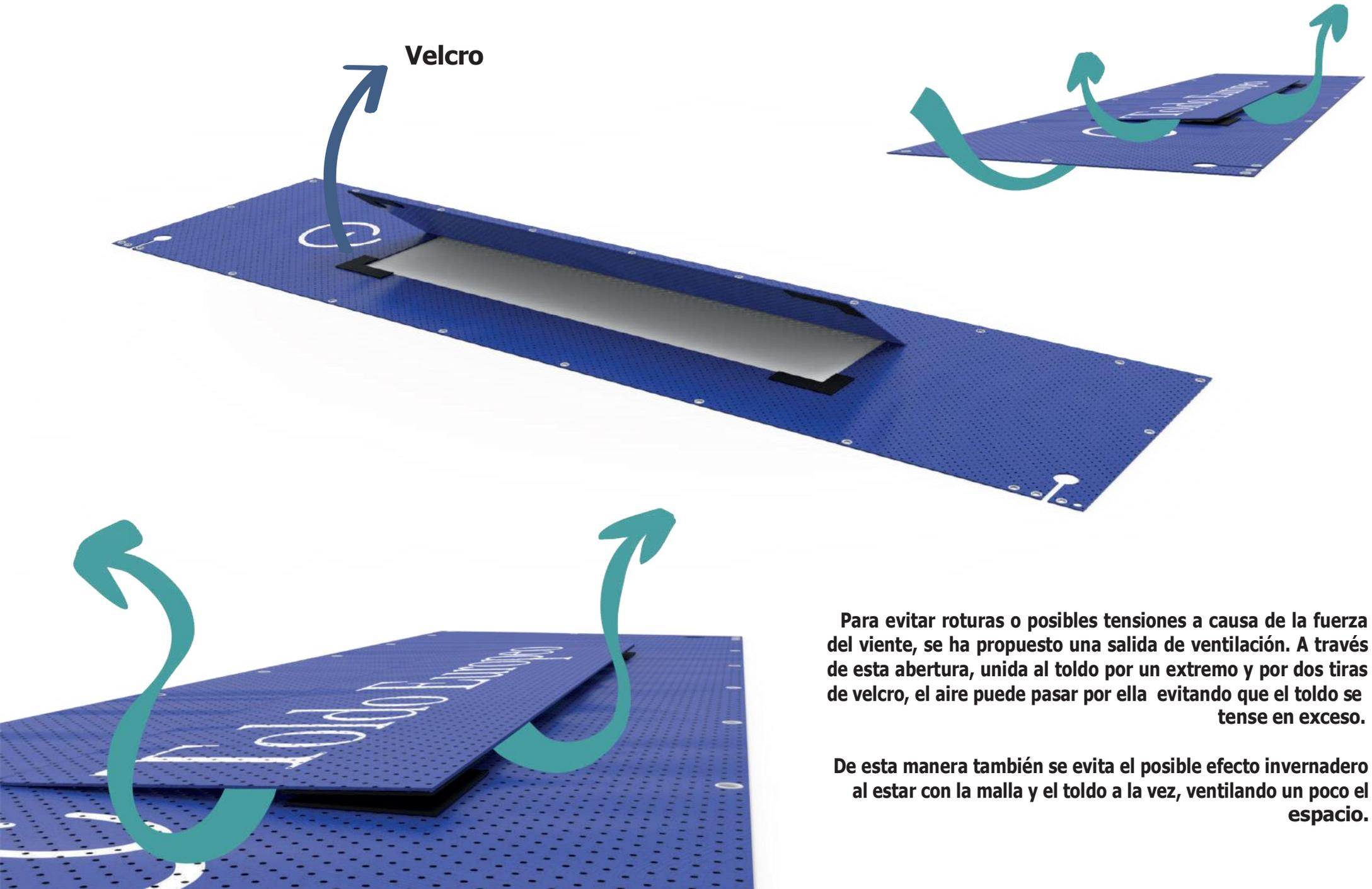
Para evitar roturas o posibles tensiones a causa de la fuerza del viento, se ha propuesto una salida de ventilación. A través de esta abertura, unida al toldo por un extremo y por dos tiras de velcro, el aire puede pasar por ella evitando que el toldo se tense en exceso.
